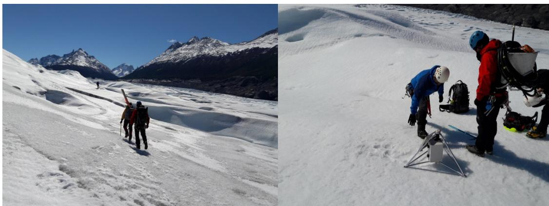
Imagem 5: Deslocamento e instalação das balizas de ablação automática sobre geleira Grey.
