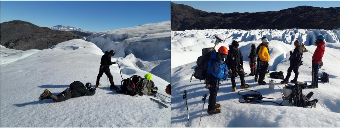
Imagem 6: Instalação das balizas de ablação sobre geleira Grey e gravação dos trabalhos científicos.
