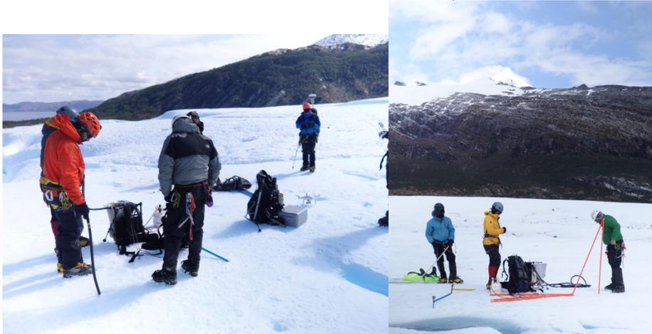
Imagem 4: Instalação das balizas de ablação sobre geleira Schiaparelli.
