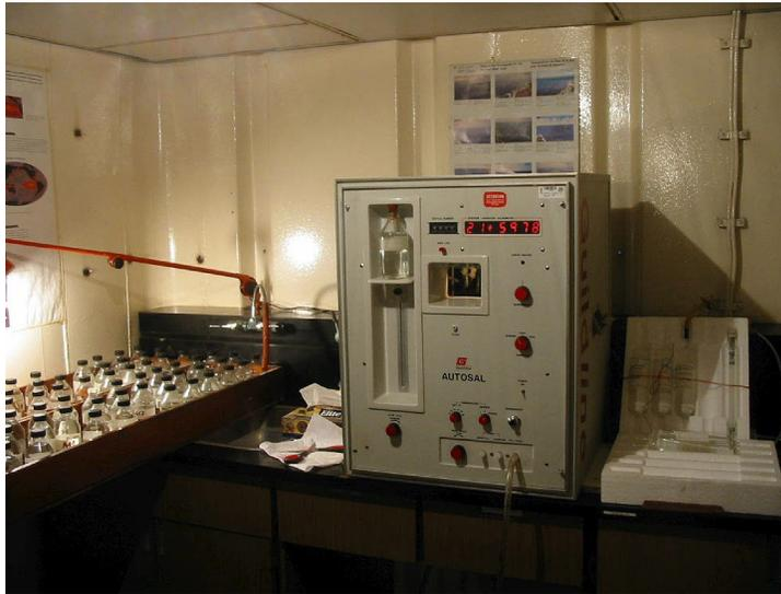
**Figura 5.11** Autosal Guildline instalado no laboratório do ARA Puerto Deseado durante o cruzeiro do projeto La Plata de inverno (foto de Carlos Balestrini).
