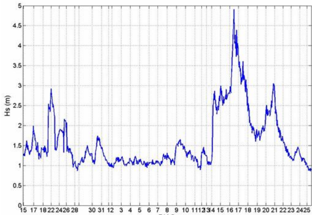
Figura 35. Altura significativa medida pelo ondógrafo direcional localizado a 32^{\circ}10'002''S e 51^{\circ}58'913''W no período entre 13 de maio e 25 de junho de 2005, durante o Experimento Cassino. (Cuchiara et al., 2007).
